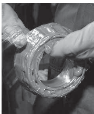
Рис. 14. Пластичная смазка позволяет легко заправить подшипник вручную.
