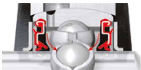
Fig. 3: Новая конструкция уплотнения для смазки
