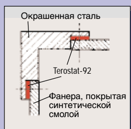
Внутренняя герметизация элементов контейнеров перед установкой боковых панелей
