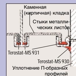
Герметизация потолков в помещениях с повышенными требованиями к чистоте
