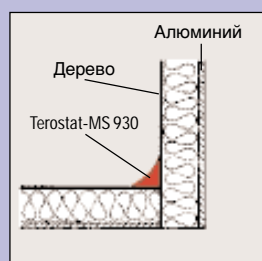
Герметизация сэндвич панелей в холодильных камерах
