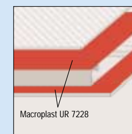
Склеивание элементов сэндвич панелей в производстве прицепов
