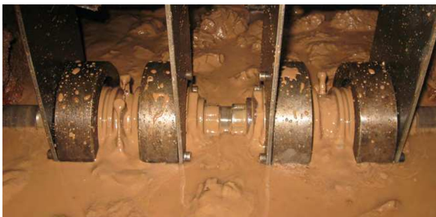
Стенд испытаний в условиях жидких загрязнений
